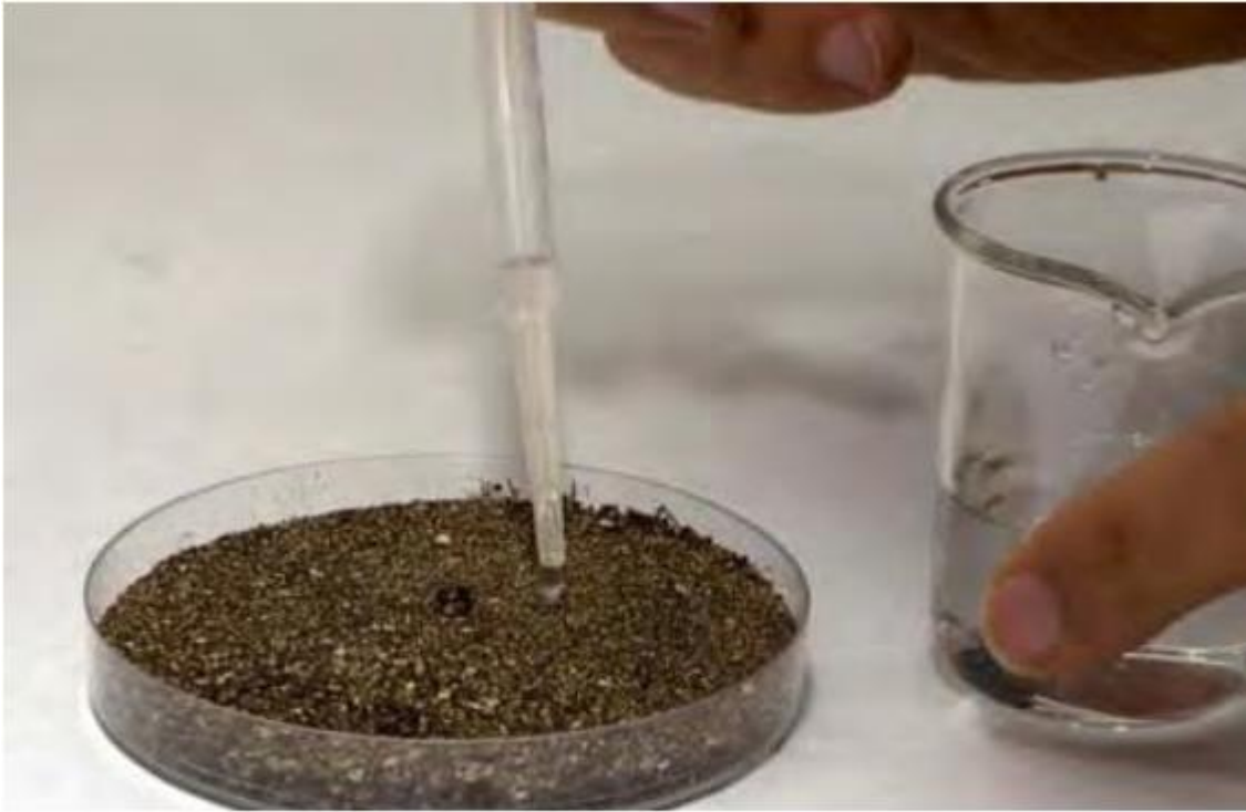
Figura 6. La deposición de la gota de agua encima del suelo debe efectuarse desde poca altura para evitar que esta se rompa con el impacto. Fuente: Badía, Ortiz y Martí (2016) .
