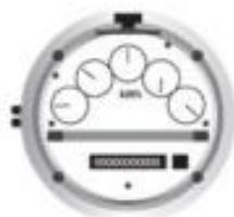
Medidor de agujas: Los datos deben ser tomados de los relojes ubicados de izquierda a derecha. Se debe anotar el número que indica la aguja de cada reloj, si ésta se encuentra entre dos números se verifica la relojería anterior. Si no ha llegado a cero(0), se toma el número inferior del reloj que se está leyendo
